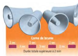
Signal d'alerte spécifique aux ouvrages hydrauliques
