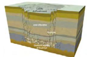
**- Effondrement généralisé :** Il se manifeste par une rupture, souvent dynamique et quasi instantanée, de tout ou partie d'une exploitation (entre le fond et la surface), affectant ainsi la stabilité des terrains de surface.
