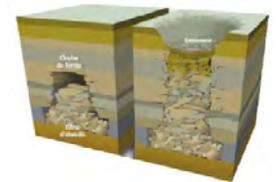
Schéma de principe d'un « fontis »
