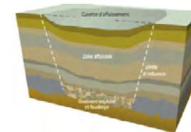
**- Effondrement localisé :** il correspond à un "fontis", un effondrement de tête d'un puits ou d'une galerie, il se caractérise par l'apparition soudaine en surface d'un cratère d'effondrement.
